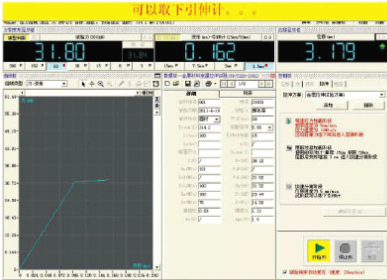
当材料进入屈服阶段后自动提示曲线引伸计
